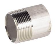
Femelle, Mâle BSP et à souder BW. Température Mini : -25°C Température Maxi: +180°C. Pression Maxi: 20 Bars. Caractéristiques: raccords inox tube filetés class 150 PN20 BSP.
