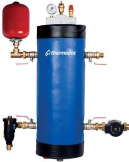
Ballon tampon prêt-à-poser 4 piquages + vase d'expansion 12L avec raccord rapide ZR558 + chandelier isolé et équipé + 4 vannes à sphère d'isolement + pot de décantation DIRTMAG + vanne de vidange + circulateur EVOSTA
