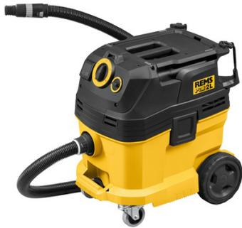
Pour aspirer les poussières sèches ou humides et les liquides sur les chantiers. Homologués EN 60335-2-69 poussières nocives ! Avec prise d'asservissement pour outils électro-portatifs ! Poids : 13,5 kg / 14,2 kg. Puissance : 1200W. Capacité cuve : 31 L. (17 L. pour liquides). Puissance d'aspiration : ? 143 m<sup>3</sup>/h. Classe de filtration (EN 60335-2-69) : valeur limite d'exposition. L : > 1 mg/m<sup>3</sup> (aspiration 99,0% poussières nocives).
