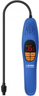
Doté d'un capteur de type semi-conducteur contrôlé par microprocesseur, LT-100-PRO2 est d'une grande sensibilité < 3gr/an pour la détection de fuite de gaz HFC, HFO, HC et azote hydrogéné (N<sub>2</sub>/H<sub>2</sub>)
