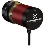
Circulateur pour installations d'eau chaude sanitaire. Equipés d'un moteur sphérique contrairement qui facilite le démontage pour l'entretien des circulateurs : dépôts calcaires. Faible consommation électrique, mesure en continu les variations de l'installation afin d'optimiser le démarrage/arrêt du circulateur et assure périodiquement un cycle "haute température" du circuit (légionellose). Entraxe 80 mm. Certifié ACS.
