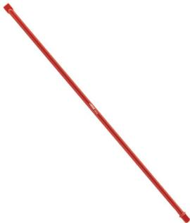
Destinée à serrer par prise intérieure les nipples d'assemblage des radiateurs en fonte. Carré d'entraînement de 18 mm. Méplat pour la prise sur les ergots intérieurs du nipple. Guide de centrage (1.1/4"). Possibilité d'entraînement par cliquet.
