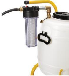
Filtre fin externe avec élément filtrant fin 90 µm, lavable à l'eau, avec grand réservoir de collecte de saletés, pour tuyau de retour avec raccord 3/4", pour rincer les chauffages au sol/muraux et éliminer la boue.
