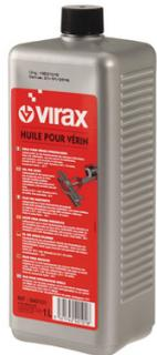
Huile minérale hydraulique hautement raffinée, indispensable au bon fonctionnement des cintreuses hydrauliques Virax (réf. 2402/2408). Très fort pouvoir de lubrification, anti-oxydation, anti-corrosion et anti-usure. Densité à 20°C : 0,87 à 0,89. Viscosité à 40°C : 22 mm<sup>2</sup>/s. Écoulement limite : - 42°C
