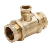
Pression d?utilisation : 5 bar. Serrage en butée sans clé dynamométrique pour les tubes PE 20, 32 et 40. Serrage au couple pour les tés réduits. Serrage par brides pour les tubes PE 63. Conforme EN 1555-3.
