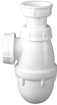
Réglable en hauteur. Siphon à culot démontable. Sortie J.C. ø40. Siphon en polypropylène. Ecrus ergonomiques pour montage rapide et sans outils. Certifié NF EN 274.
