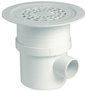
Pour sols plastiques étanches. PVC blanc. Grille ronde PVC. Garde d'eau 50 mm. Hauteur ajustable. Sortie Ø 50 mâle horizontale ou verticale ou Ø 63 femelle.
