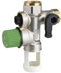
Tarés à 7 bars. Il incorpore: Robinet de fermeture, dispositif de purge ou vidange, dispositif antiretour.
