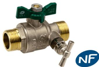
Corps laiton CW617N nickelé et interne brossé. Sphère laiton chromé. Presse étoupe PTFE + Joint torique EPDM. Passage intégral. Axe inéjectable. Poignée anti corrosion. Bille pleine et percée jusqu'au DN 11/2 (évite la stagnation d'eau entre le corps et la sphère). ACS et conforme 4MS.
