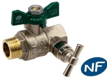
Vanne NF Mâle/Femelle avec purge avec poignée acier plate verte. Corps laiton nickelé et interne brossé. Sphère laiton chromé. Presse étoupe PTFE + Joint torique EPDM. Passage intégral. Garantie 10 ans. ACS et conforme 4MS.
