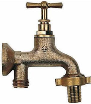
Robinet de puisage en laiton brossé avec raccord au nez. Applique de fixation murale incorporée. Pose en applique. Filetage entrée : 15x21 mm - Filetage sortie : 20x27 mm et nez : 15x21 mm. Raccord nez : Ø 50,8 - Diamètre du tuyau 14.
