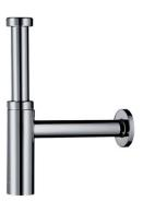
Siphon design chromé 11/4? pour lavabo. Tube d?entrée réglable de 60 à 165 mm. Tube de sortie 330 mm. Rosace Ø 72 mm.
