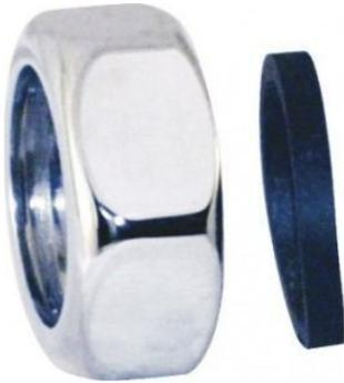
Ecrou raccord G 1¼ ( 33x42 ) avec joint plat pour tube diamètre 32 extérieur.
