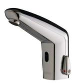
Mitigeur optoélectronique sur plage pour lavabo réf.55160 PRESTO avec butée limitation de température 6 positions, alimentation par pile lithium 6 V intégrée dans le robinet.
