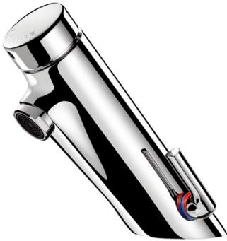
Mitigeur de lavabo temporisé sur vasque. Déclenchement souple. Temporisation ~7 secondes. Débit préréglé à 3 l/min à 3 bar, ajustable de 1,4 à 6 l/min. Aérateur antitartre. Corps en laiton massif chromé. Flexibles PEX F3/8 avec robinets d'arrêt, filtres et clapets antiretour. Fixation renforcée par 2 tiges Inox. Réglage de température latéral avec manette standard et butée de température réglable. Adapté aux PMR. Garantie 10 ans.
