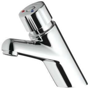
Bouton chromé, avec robinets d'arrêt, clapets et filtres. Durée d'écoulement 15 secondes. Débit d'utilisation 6 L/mn. Sélection de la température par rotation du volant. Arrêt de l'écoulement en cas de blocage du bouton.
