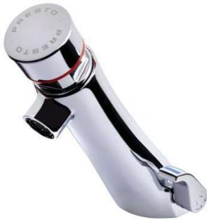
Mitigeur bi-commande temporisé sur plage, avec sélecteur de température latéral. De type Presto NEO réf. 68400 ou techniquement équivalent. Avec mécanisme à rubis auto nettoyé par fil frein, débit préréglé à 3 l/mn et une temporisation de 15 secondes. Réglage de débit interne. Bouton poussoir anti-rotation. Avec butée de température, flexibles PEX, robinets d'arrêt et filtres.
