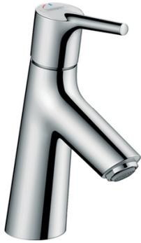
ComfortZone 80. Avec bec rotatif 360°. Cartouche M1 à disques céramiques. Mousseur QuickClean. Verrouillage de poignée Boltic. Limiteur de température. Limiteur de débit 5 l/min. Vidage G 1¼ avec tirette de vidage latérale. Hauteur totale 180 mm, Saillie 97 mm, C3.
