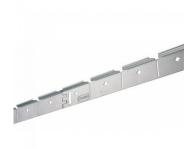
Ce kit comprend: 4 supports métalliques de 60 cm, 12 chevilles métalliques de diamètre 8 mm pour cloisons en plaque de plâtre. Adhésifs doubles faces qui facilitent le positionnement. Extrémités des supports assurent la continuité du supportage. Sécables tous les 10 cm. Supports pliables. Fixation rapide avec tout type de cheville.
