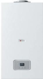
Corps de chaudière ThemaClassic Bas-NOx murale basse température d'une puissance de 25 kW avec production d'eau chaude en mini-accumulation. Evacuation des fumées par raccordement VMC. Fonctionnement au gaz naturel. Conforme aux exigences de la réglementation Ecoconcept.
