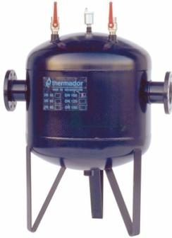
Corps acier noir. Pression maxi 6 bar. Température maxi 110°C. Orifices prévus en partie supérieure pour pose purgeurs, manometres : 2 x 1 F, 1 x 1/2 F. Orifices prévus en partie inférieure pour pose vanne de purge : 1 x 1"1/4 F.
