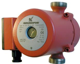
Circulateur monovitesse domestique pour bouclage E.C.S. Certification ACS. Indice de protection IP 42. Classe d'isolation F. Pression maximale de service 10 bar. Débit jusqu'à 4 m<sup>3</sup>/h. Température du liquide +2 °C à +110 °C (+60 °C maxi pour ECS). Entraxe 150 mm.
