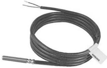
Sonde à câble pour ballon ECS. Ni 1000ohms/0°C.
