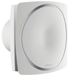
Modèle Curv Genius 100 IH à 120 IH 2 vitesses pour salle de bains et pièce à fort taux d'humidité : mode hygiène (20 m<sup>3</sup>/h à 45 m<sup>3</sup>/h) : fonctionnement continu + mode boost (50 m<sup>3</sup>/h à 135 m<sup>3</sup>/h) : mise en route automatique lorsque le taux d'humidité de la pièce varie rapidement
