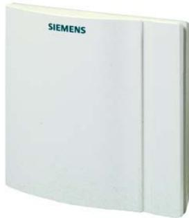
Modèle RAA 11 avec réglage caché, pour systèmes de chauffage seul ou rafraîchissement seul. Régulation tout-ou-rien avec comportement P, technologie bifilaire de membrane à gaz, aucune possibilité de réglage à l'extérieur de l'appareil.
