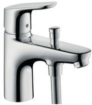
Mitigeur bain/douche C2 avec cartouche à 2 vitesses chromé. Longueur 172 mm - 179,5 mm. 2 sorties = 2 fonctions. Type de raccordement: raccords S. Entraxe: 150 mm ± 12 mm. Type de jet du mitigeur: jet normal. Débit maximal sous 3 bars de pression: 22 l/min. Cartouche céramique à 2 vitesses. Limiteur de température réglable. Inverseur avec réinitialisation automatique. Sécurité contre le retour de l'eau. Avec silencieux. Convient au chauffe-eau instantané. E3/1, C2, A2, U3.
