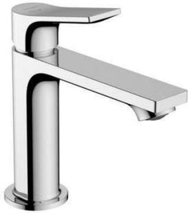
Mitigeur de lavabo, garniture de vidage. ComfortZone 110. Projection : 133 mm. Hauteur du bec : 109 mm. Jet normal. Débit maximal à 3 bars : 5 l/min. Cartouche céramique bas débit. Limiteur de température réglable. Convient au chauffe-eau instantané. Garniture de vidage 1"1/4. Garniture de vidage : synthétique. E00, CH3, A3, U3. CoolStart : démarrage en eau froide en position de poignée centrée.
