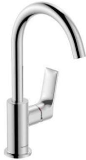
Mitigeur de lavabo, garniture de vidage. ComfortZone 210. Projection : 154 mm. Hauteur du bec : 222 mm. Bec orientable 120°. Type de jet : jet normal. Débit maximal à 3 bars: 5 l/min. Cartouche céramique bas débit. Limiteur de température réglable. Convient au chauffe-eau instantané. Garniture de vidage 1"1/4. Matériau de la garniture de vidage : synthétique.
