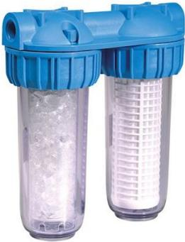
Station de filtration double STATION DUO-BX - Composée d'un double porte filtre, d'une cartouche filtrante FA10SX de 25 et d'une cartouche HA10SX pour traitement anti-calcaire - Raccordements 3/4" F/F
