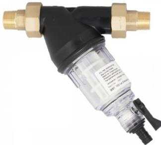
Le filtre BWT Fine retient les impuretés solides présentes dans les eaux de ville ou de puisage. Le filtre est livré équipé de : raccords filetés en laiton, un corps de filtre en noryl, un système d'évacuation des impuretés par purge et un tamis nettoyable 90 microns. Pression max : 8 bars - Température de l'eau : min 5° et max 30°C.
