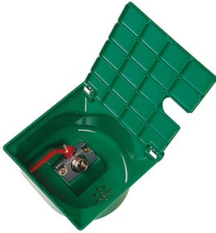
? Diamètre de l'entrée de la bouche 20 x 27 (3/4??). Diamètre de la sortie de la bouche 20 x 27 (3/4??). ? Le modèle BRM2027 est standard, avec un robinet à potence en laiton. ? Les versions BAC227 sont carrées, et le couvercle peut se fermer avec le tuyau branché ? La vanne est en laiton nickelé mat, et dispose d'une Attestation de Conformité Sanitaire. ? Le clapet de fermeture est une version à robinet 1/4 de tour 20 x 27 avec poignée gainée.
