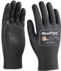
Gant. Usage manutention lourde. Lavable 30°. Support tricoté sans couture Nylon/Lycra®. Très résistant à l'abrasion et à la déchirure. Très agrippant avec ses picots nitrile sur paume et doigts. Laisse le sens tactile intact. Respirabilité 360°. CE 4131 - NF EN 388 - NF EN 420 + A1
