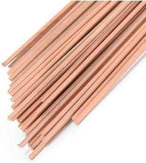
Cet alliage à haute fluidité s'applique très facilement, et permet ainsi d'assembler les pièces de plomberie, d'air conditionné, de ventilation, et de bien d'autres domaines. Grâce à ses 7% de Phosphore, il est auto-décapant et ne nécessite donc pas d'ajout de flux. Il est également composé de 2% d'argent pour réduire le point de liquidus, augmenter la conductivité électrique et la ductilité, et affiner l'alliage.
