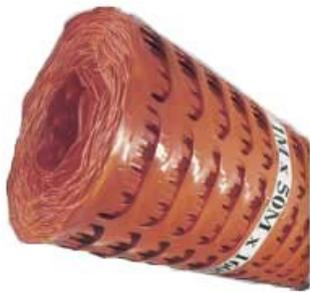
Prévient de la présence d'un ouvrage enterré, permet d'identifier la nature de l'ouvrage en fonction de la couleur et de préciser son orientation. Dispositif avertisseur destiné à être posé dans la tranchée à une distance de 200mm à 300mm au dessus de l'objet
