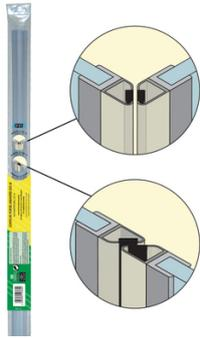
Conçus pour l'étanchéité et la fermeture à 90° et 180°, des côtés de portes de douche en verre et acrylique de 5 à 8 mm d'épaisseur. Ils se clipsent et se coupent facilement pour s'ajuster au côté de la porte de douche.
