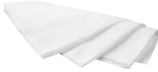
Chiffon absorbant non pelucheux pour nettoyer et dégraisser les tuyaux, les manchons et les raccords à coller ou à souder en PVC (rigide), PVC-C, ABS, PE, PP, PVDF et PB. À utiliser en combinaison avec Cleaner et PE Cleaner. Convient aussi pour éliminer les restes de colle fraîche non durcie. Dévidoir 100 chiffons 23 x 41 cm.
