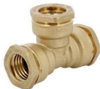
Dimensions : DN20 à DN90 Raccordement : Femelle, Femelle BSP et sur tube polyéthylène Température Mini : +4°C Température Maxi : +40°C Pression Maxi : 16 Bars jusqu'au DN63 (10 bars au-delà) Caractéristiques : Raccords laiton pour tube Polyéthylène Joint torique NBR Montage sur tube sans démontage du raccord
