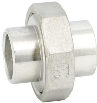
Température Mini : -25°C. Température Maxi : +180°C. Pression Maxi : 20 Bars. Fabrication par procédé de cire perdue. Raccords moulés. Etanchéité Métal-Métal.
