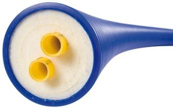
Conduite double souterraine flexible pré-isolée et auto compensatrice. Principalement utilisée pour le transport de l'eau de chauffage mais également de l'eau potable (chaude), eaux résiduaires ou autres fluides. Prix au ML.
