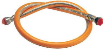
Entrée / Sortie : Ecrou 20x150 / Ecrou G 15x21. Certification : conforme à la norme NF D 36-125. Type de gaz : gaz butane, gaz propane. Température : de -5°C à +60°C (tests qualité réalisés jusqu'à -20°C). Durée de vie illimitée.
