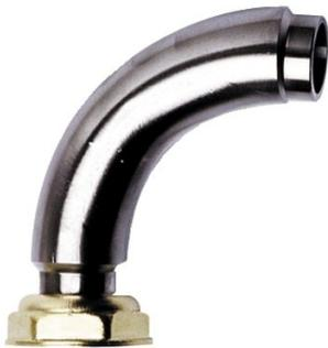
Pression maximale d'utilisation : 500 mbar. Coude à souder ou à braser sur conduite verticale (acier ou cuivre), écrou prisonnier tournant femelle plombable et douille à Joint Plat Compteur.
