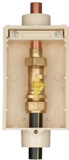
Pression maximale d'utilisation : 5 bar - Dimensions : L 155 x H 270 x P 106 mm - Coffret livré avec robinet 1/4 de tour et raccord de sortie avec douille à braser sur cuivre - Porte pleine, démontable, équipée d'une serrure triangulaire - Coffret livré équipé non monté
