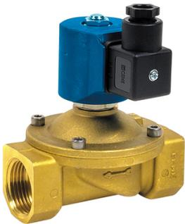
Electrovanne normalement fermée. Noyau et pièces internes en acier inoxydable. Protection électrique IP65. Ps Fluide 0-10 bars. Pas de différentiel pression. Fluide : -5°C- +80°C. Alimentation 220 V.
