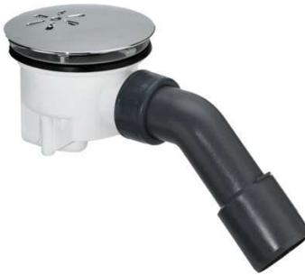
Bonde plastique grand débit Pour receveur avec orifice Ø 90 mm. Sortie orientable à coller Ø 40 et Ø 50. Système autonettoyant.
