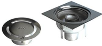
Acier inoxydable AISI 304. Sortie DN40/DN50/DN60 horizontable sécable. Avec natte périphérique de reprise d'étanchéité sous carrelage de 30 mm. Grille Slot en acier inoxydable brossé avec fente accès PMR. Gardes d'eau de 15 mm, 30 mm ou 50 mm. Classe K3.
