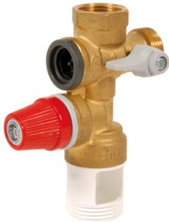
Groupe de sécurité vertical 20x27 GSL Thermador. Produit respectant la nature : sans chrome ni nickel. Corps en laiton. Ecroû tournant isolant. Garde d'air orientable Soupape démontable pour nettoyage.
